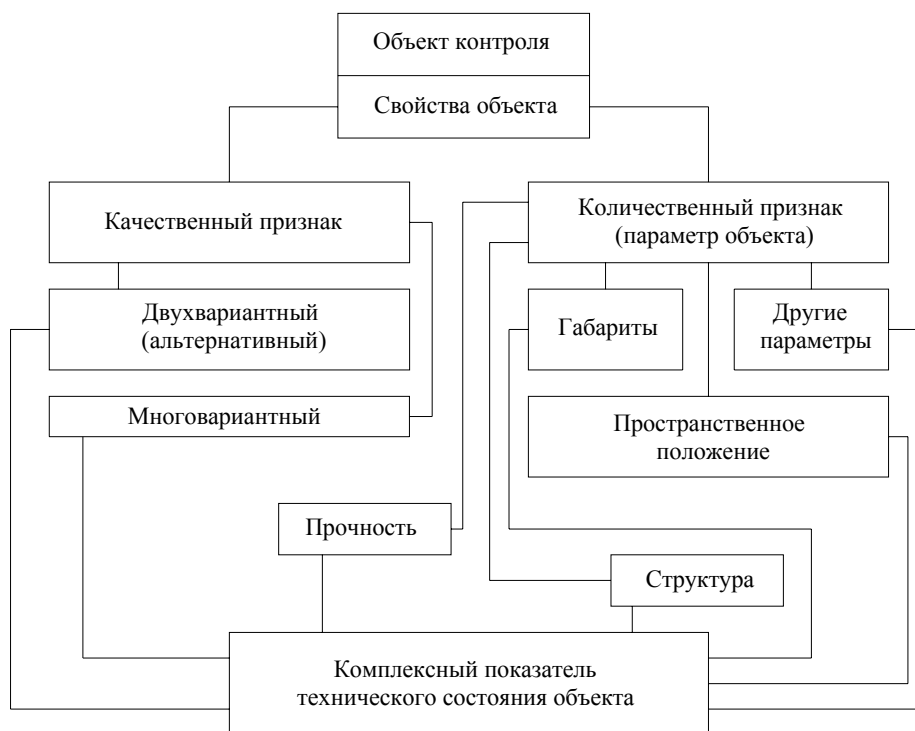
Рисунок 5.2 – Определение технического состояния объекта по нормированным признакам
